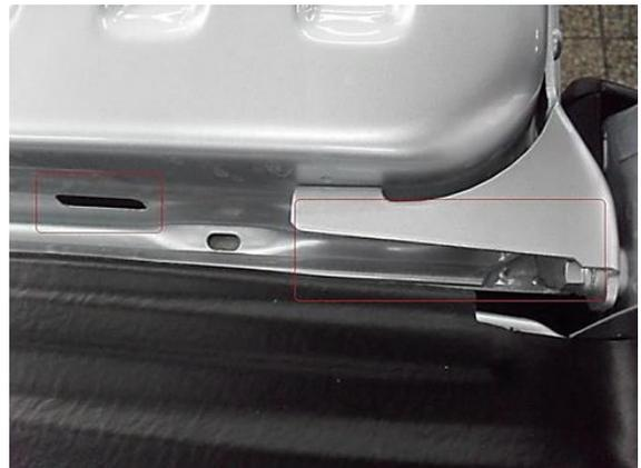
6) Dabei nutzen Sie einen vorhandenen Spalt an der Stoßstange oder bohren ein kleines Loch durch die Plastikverkleidung. Achten Sie darauf, den Kabelbaum nicht zu beschädigen.
