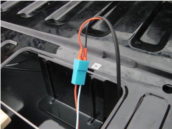
5) Führen Sie nun das Kabel fahrerseitig aus der Heckklappe und unter der Ladefläche bis zum fahrerseitigen hinteren Radlauf
