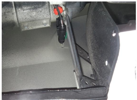
9) Verbinden Sie die Kabel mit den mitgelieferten Kabelverbindern an dem 2-poligen ZV Stecker des Fahrzeugs.
