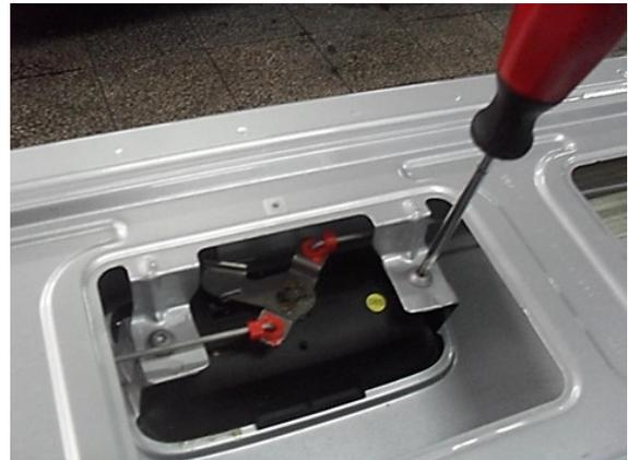
3) Befestigen Sie nun die Basisplatte mit Stellmotor mit den beiden Muttern aus 2).
